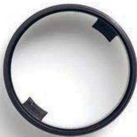
Die Holz-Einschraubmuffe ist das Einbaumodul für den flächenbündigen, rahmenlosen Einbau des DOT-Systems in abgehängte Holzdecken. In diese wird ein Loch gebohrt und die Einschraubmuffe wird mittels Gewinde in die Holzdecke eingedreht. Durch eine feine Schattenfuge von 1,5 mm werden auftretende Toleranzen aufgenommen. Der kleinstmögliche Punkt an der Decke, und Holz und Licht werden nahezu eins.
